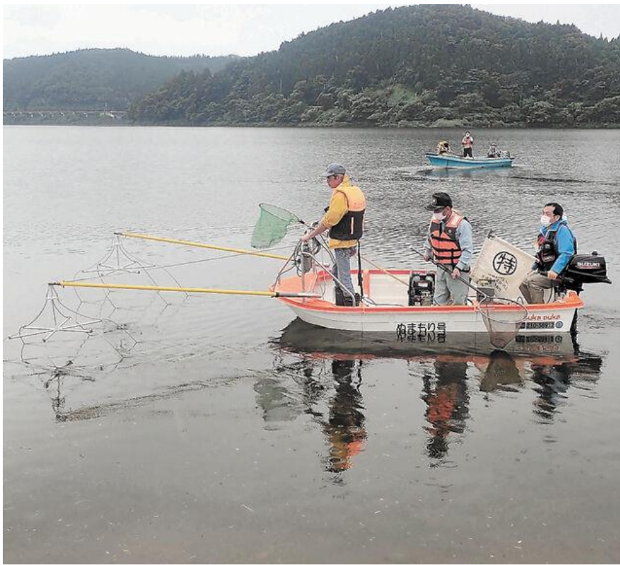
はなやまこ 花山湖でブラックバスを捕る電気ショッカーボート
